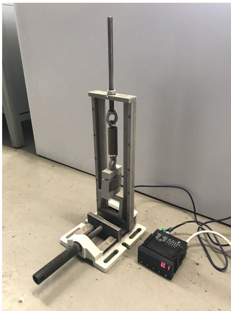
Obr. 16: Měřící zařízení pro zkoušku icephobicity
