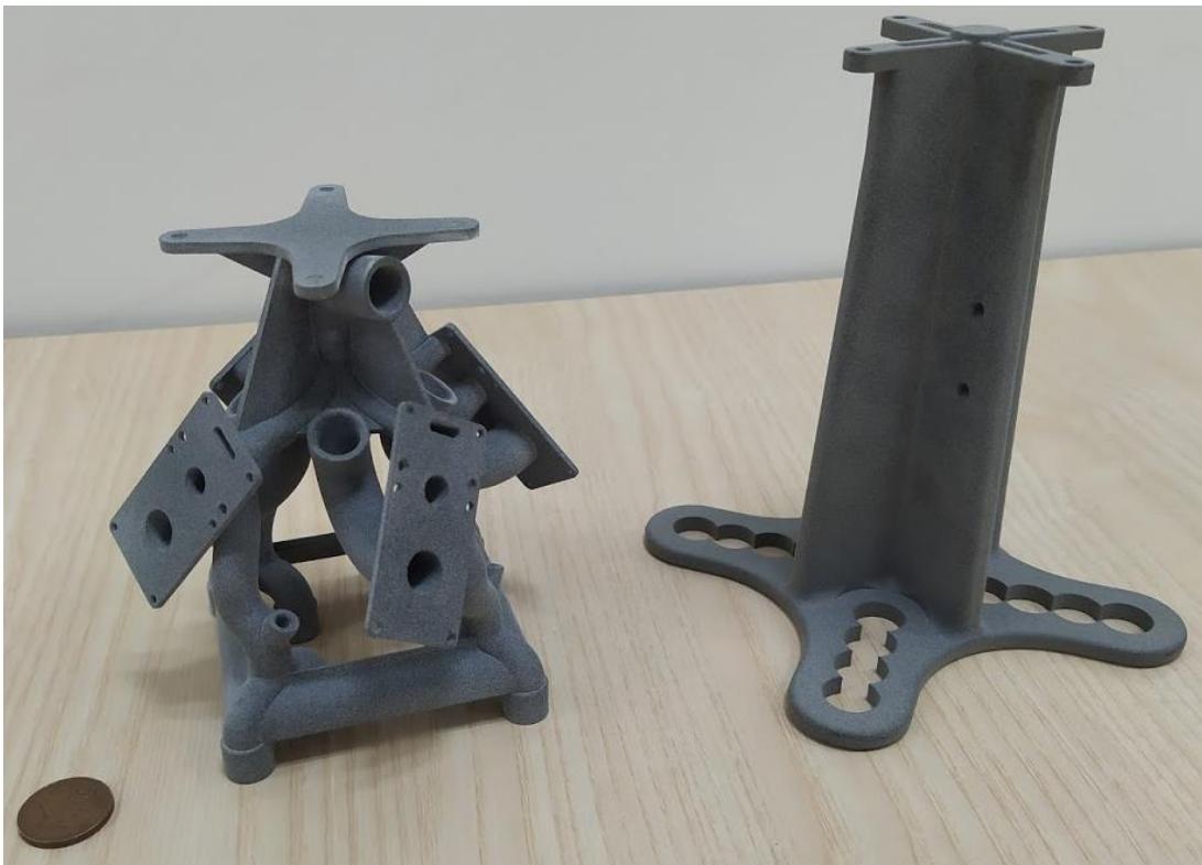
Obr. 7.3 Rozměrové porovnání podtlakových hlavic projektu Denso. Vlevo těleso navrženého nového řešení, vpravo původní těleso.
