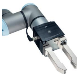
Obr. 3.16 GRIPKIT Dvouprsté chapadlo [13]
