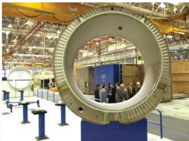
Obrázek 7.3 - Příklad nerozdělené akustické vložky pro motorovou gondolu letounu A380
