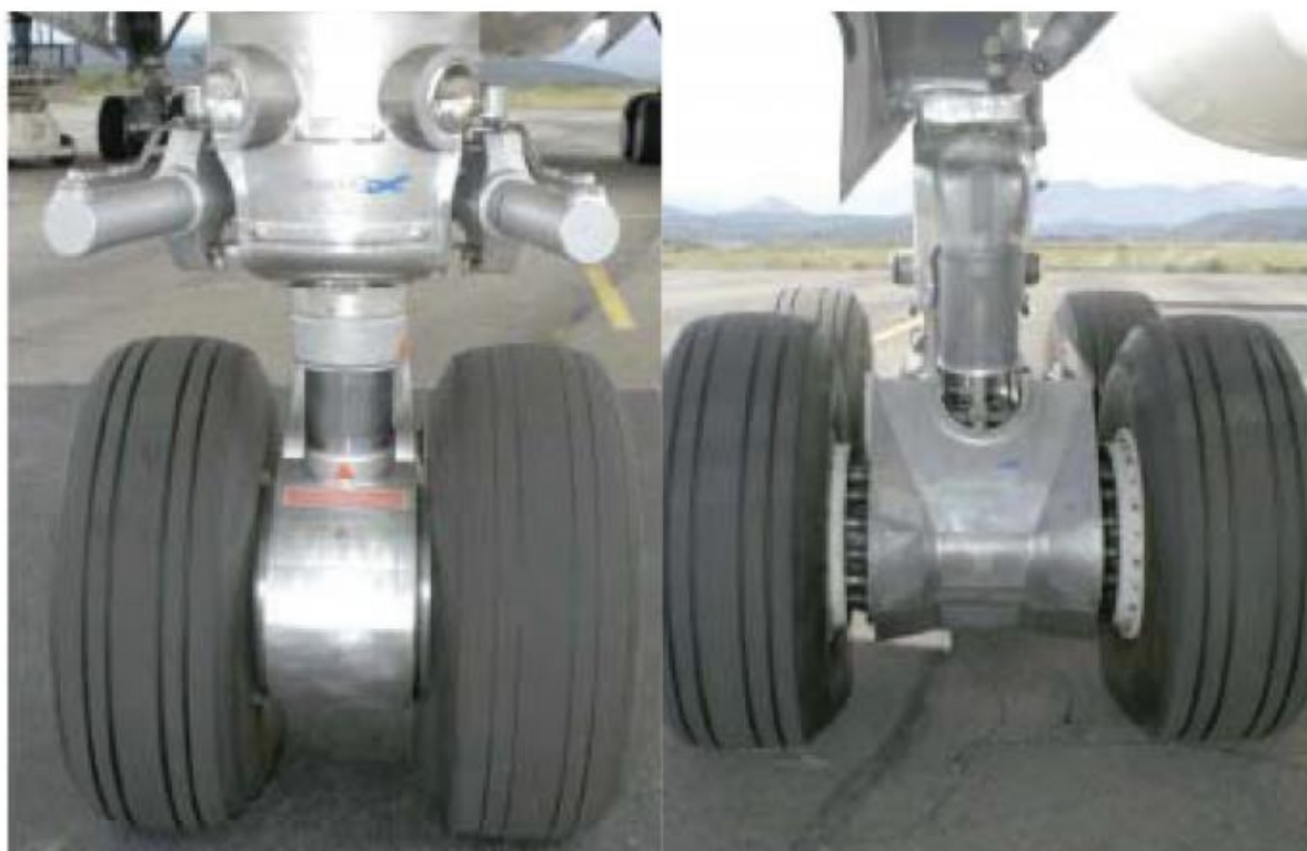
Obrázek 7.11 - Příďový (vlevo) a hlavní (vpravo) zakrytovaný přistávací podvozek měřený v rámci projektu SILENCER
