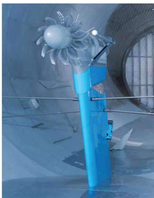
Obrázek 7.7 - Motor HERA společnosti Secma testovaný v aerodynamickém tunelu S1 francouzských laboratoří Onera (2013)
