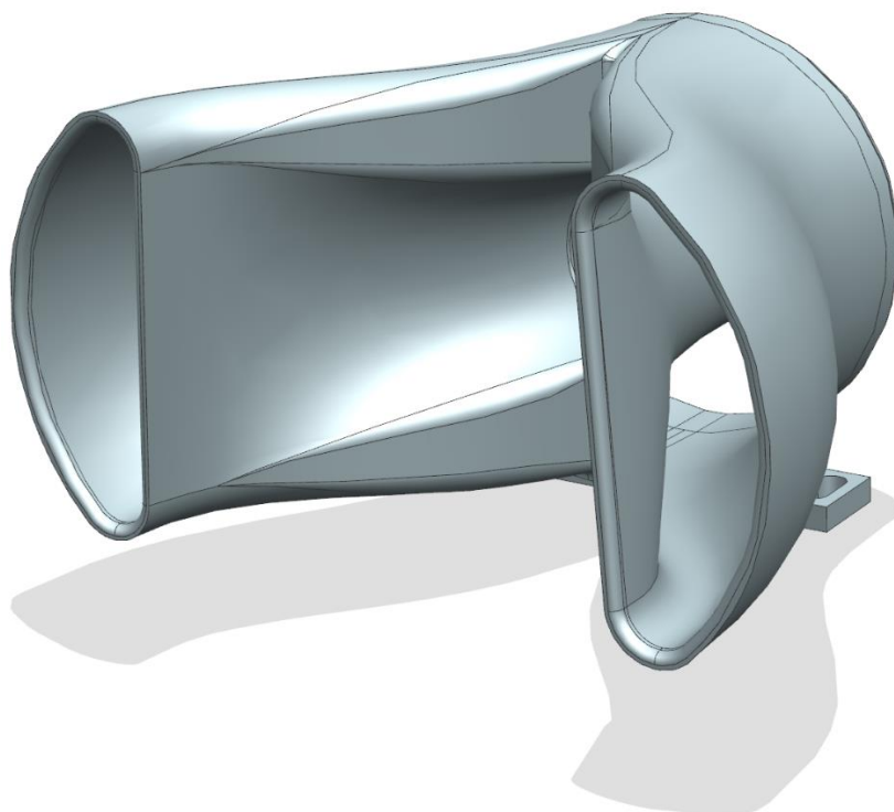
Obrázek 8.3 - Počítačový model upraveného vstupního ústrojí pro měřicí stand (Přední pohled)
