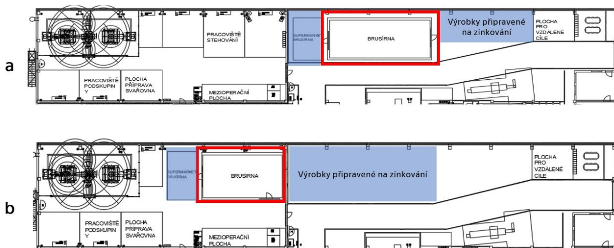
Obrázek 31 – Možnosti uspořádání brusírny. (a) - umístění v prostorech u brány; (b) - propojení se svařovnou. Zdroj: autor
