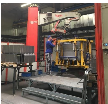
Obrázek 24 - Pracoviště robotického svařování. Stehování nádoby v přípravku. Zdroj: autor
