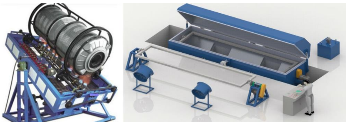
Obrázek 2: a) (vlevo) Stroj typu Rock-and-Roll s otevřenou konstrukcí a ohřevem pomocí plynových hořáků. b) (vpravo) Stroj s uzavíratelnou ohřívací komorou a zvlášť stanovištěm pro chlazení. [7, 8]
