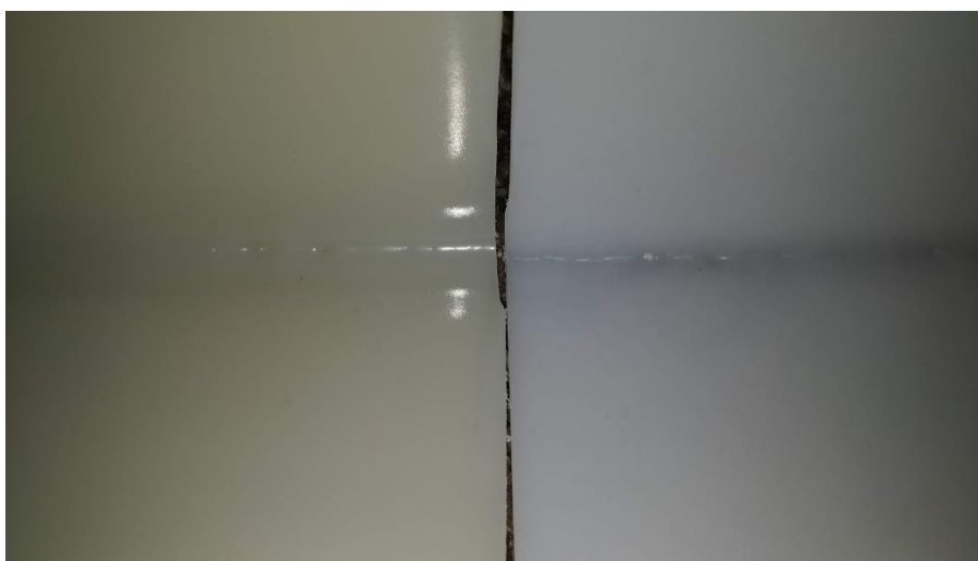
Obrázek 8: Porovnání přepečeného materiálu (vlevo) a správně připraveného (vpravo), vnitřní stěna vzorku.
