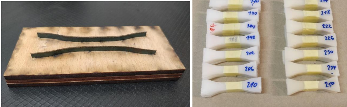
Obrázek 16: Vlevo vystřihovací nástroj. Vpravo připravená zkušební tělíska pro zkoušku tahem.
