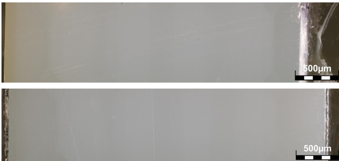
Obrázek 24: Nahoře – zažloutnutí vnější strany vzorku (levá strana) připraveného na teplotu 250 °C, dole vzorek připravený na teplotu 230 °C pro porovnání.
