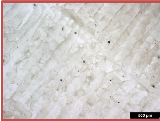
as-built (vzorek AS)
