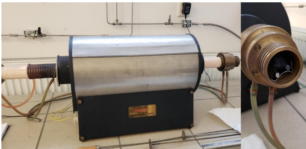
Obrázek 40 Trubková žíhací pec
