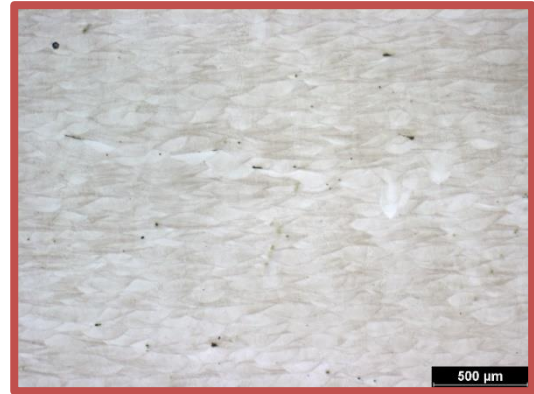
as-built (vzorek AS)
