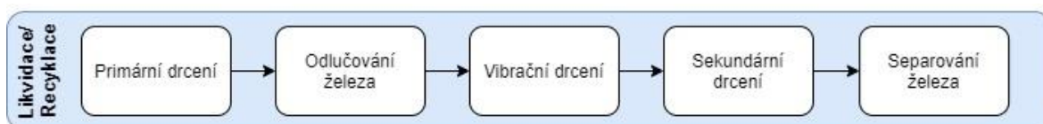
Obrázek 18: Proces likvidace/recyklace betonových prefabrikátů
