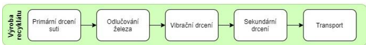
Obrázek 11: Proces výroby recyklátu
