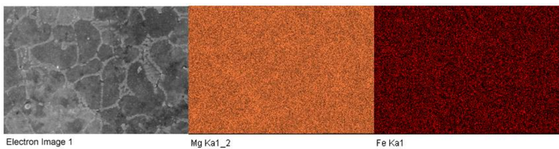
Obr.35 – EDS analýza vzorku P7 (300 °C/2 h)
