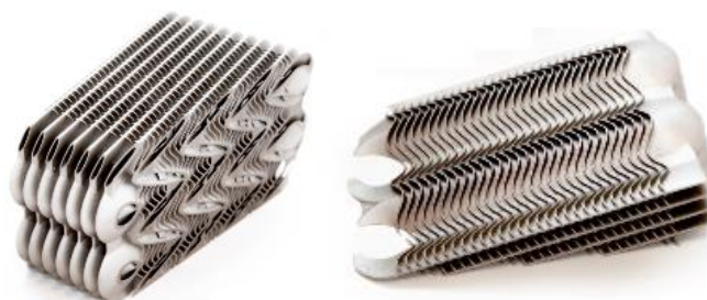
Obr.14 – odlitek ze slitiny AlSi10Mg [41]
