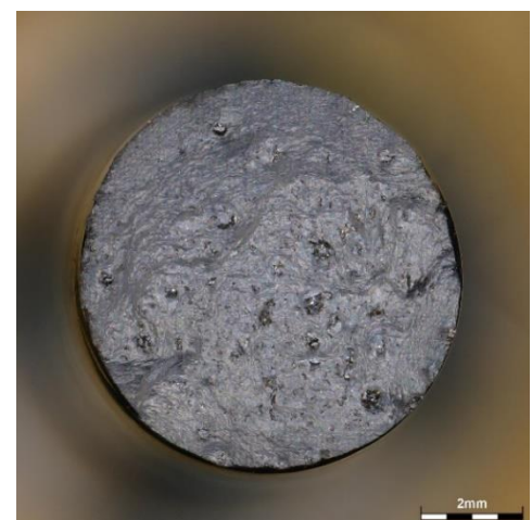
e) E17-300 °C/2 h / chlazení do vody
