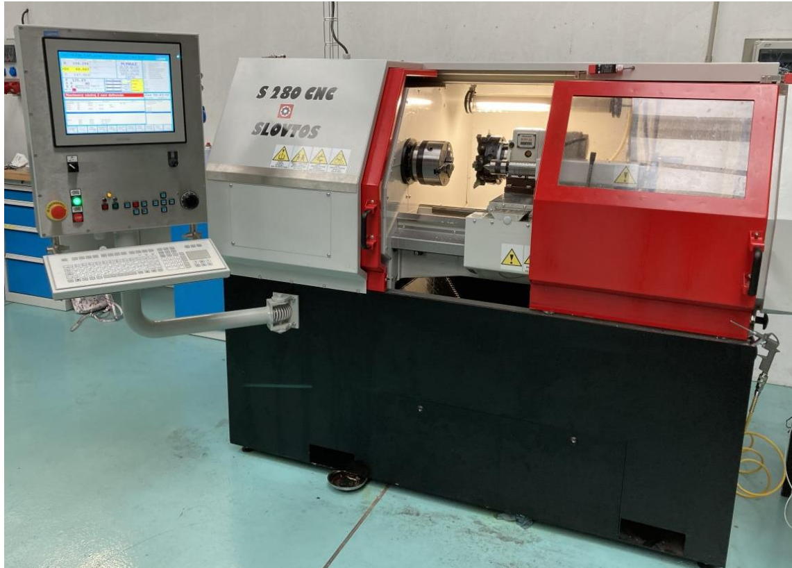
Obr.19. – soustruh Slovtos S 280 CNC
