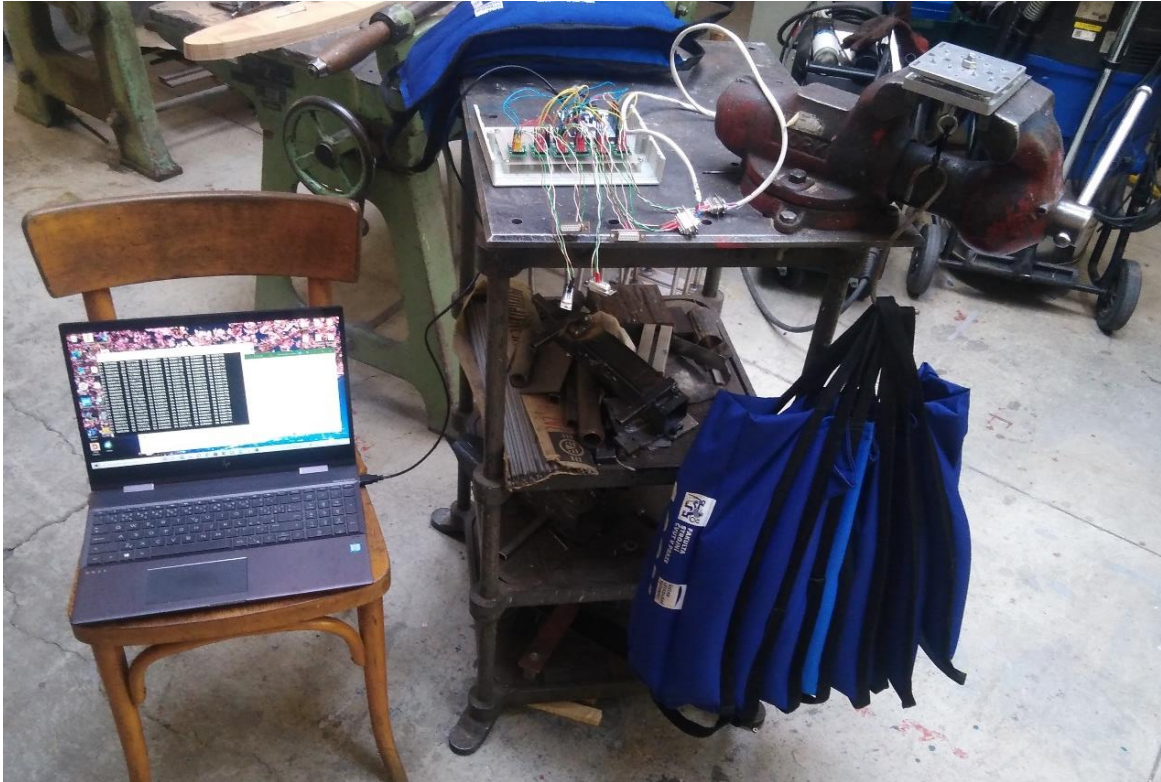
Obrázek 32 Zatěžování měřicího systému
