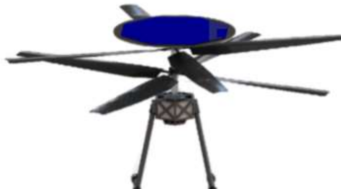
Obr. 9 Mars Science Helicopter – koaxiální konfigurace
