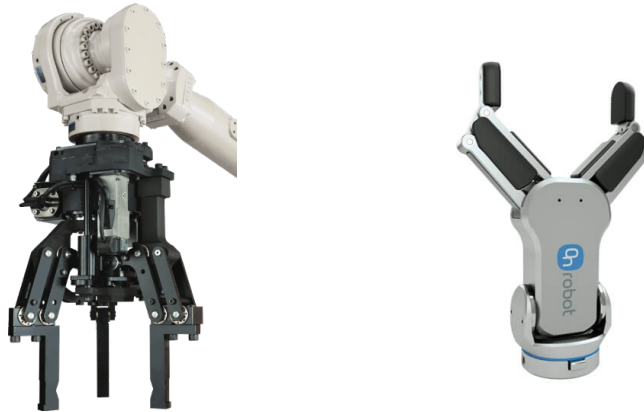
Obrázek 2.4: FLEX HAND FH360-01 NACHI a RG6 Onrobot [15][16]
