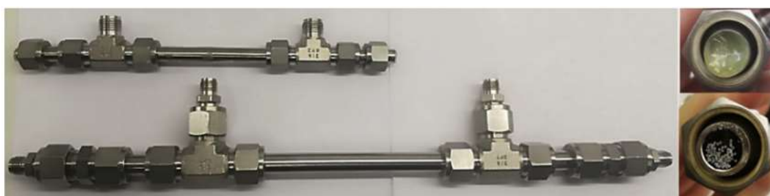
obr. 20: Membránové moduly použité v laboratorním měření a v pilotním zařízení [20]
