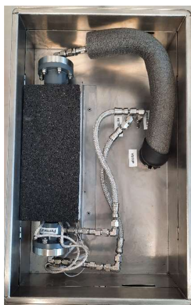
obr. 23: Horní pohled na termostatický box a umístění membránového modulu
