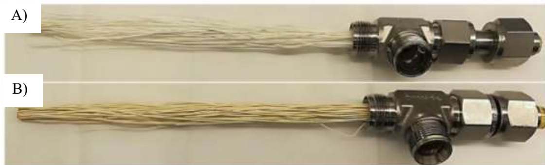
obr. 21: Porovnání dutých vláken membránového modulu A) před měřením, B) po měření [20]
