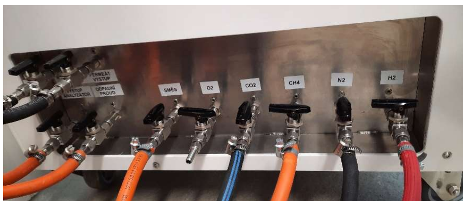
obr. 24: Boční pohled na membránovou jednotku RALEX GSU-LAB-200
