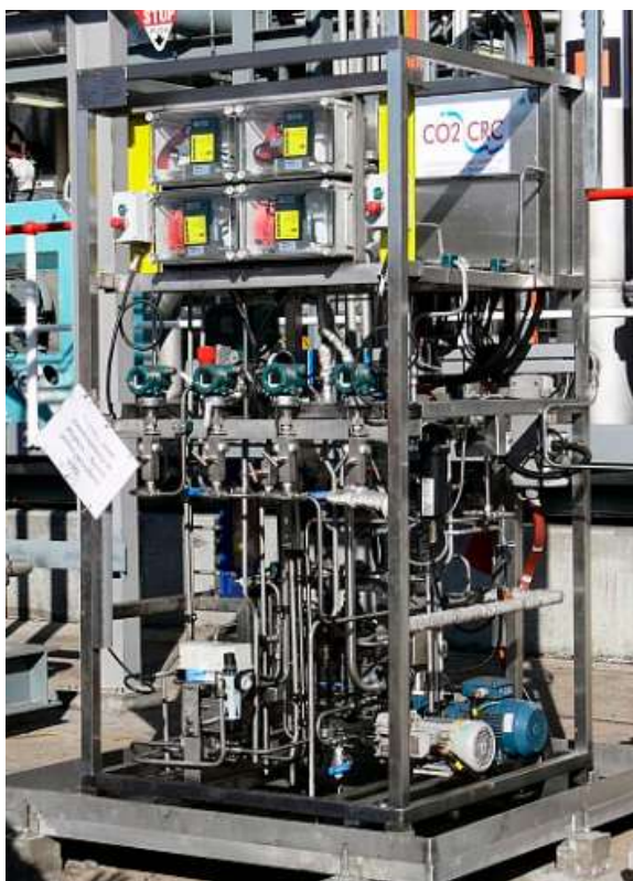
obr. 15: Membránové pilotní zařízení na separaci CO 2 [16]
