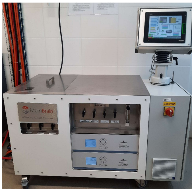
obr. 22: Čelní pohled na membránovou jednotku RALEX GSU-LAB-200
