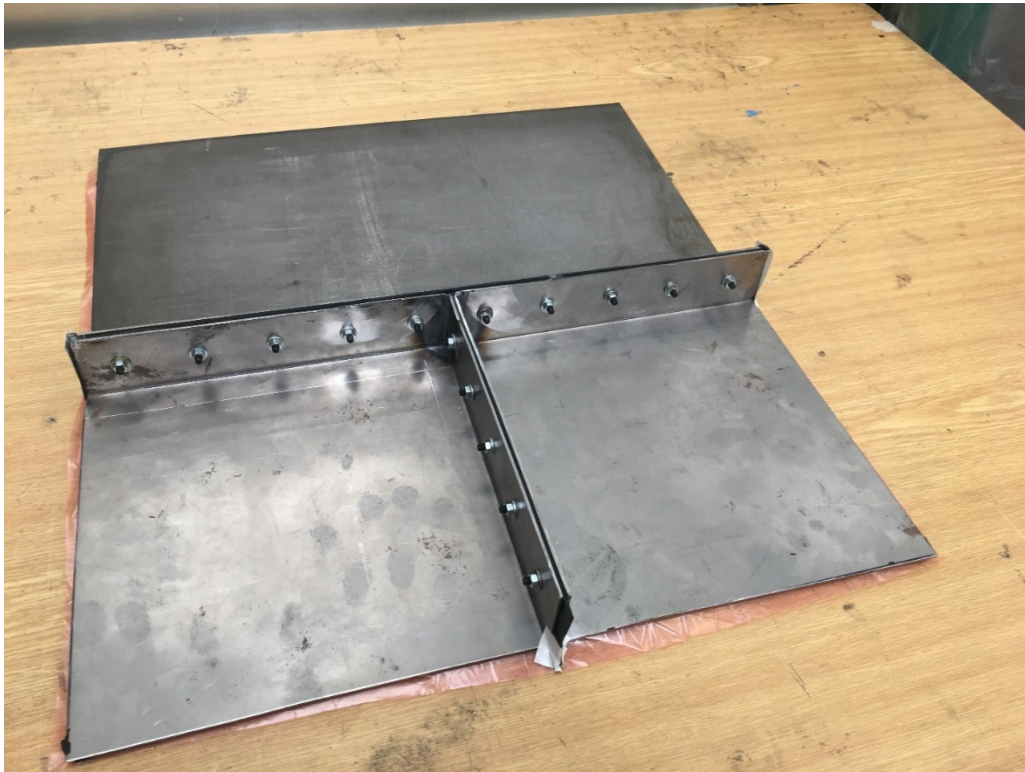
Obrázek 59: Vzorek reprezentující spoj 3 panelů s T spojem
