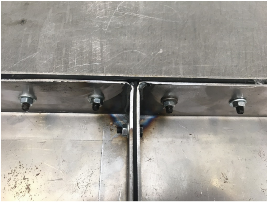
Obrázek 57: Detail těsněného T spoje v kontaktu 3 panelů
