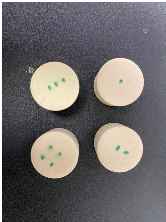
Obrázek 14 Zadní strany čtyř 3D vytištěných PEEKových jamek s označením
