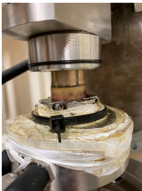
Obrázek 22 Pouzdro naplněné bovinním sérem těsně před spuštěním experimentu.
