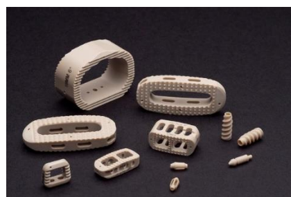
Obrázek 6 variace implanátů pro stabilizaci páteře z 3D tištěného PEEK [19]
