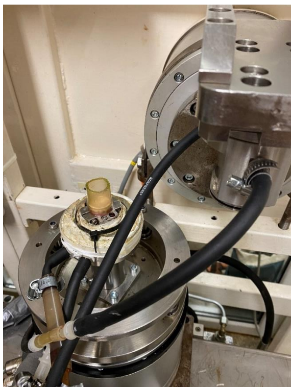
Obrázek 21 Elastické pouzdro udržující mazivo mezi vzorky během experimentu. Pouzdro je zasazeno kolem jamky, aby se hlavice mohla volně pohybovat.
