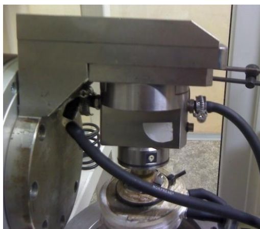
Obrázek 18 Na fotografii je zachycena horní část testovacího zařízení, kam se upíná hlavice. Na této části byl nalepen terčik, na kterém byla měřena teplota termokamerou.
