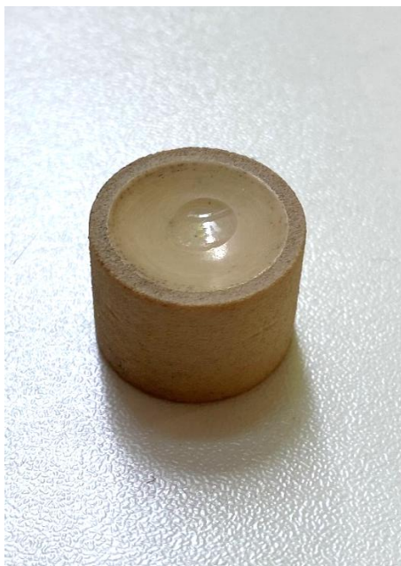
Obrázek 41 Fotografie jamky z 3D tištěného PEEKu po otěrovém experimentu. Lesklá část uprostřed jamky je vydřenou oblastí.
