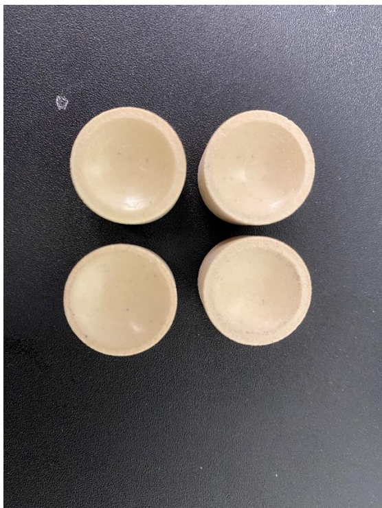
Obrázek 13 Funkční plochy čtyř 3D vytištěných PEEKových jamek
