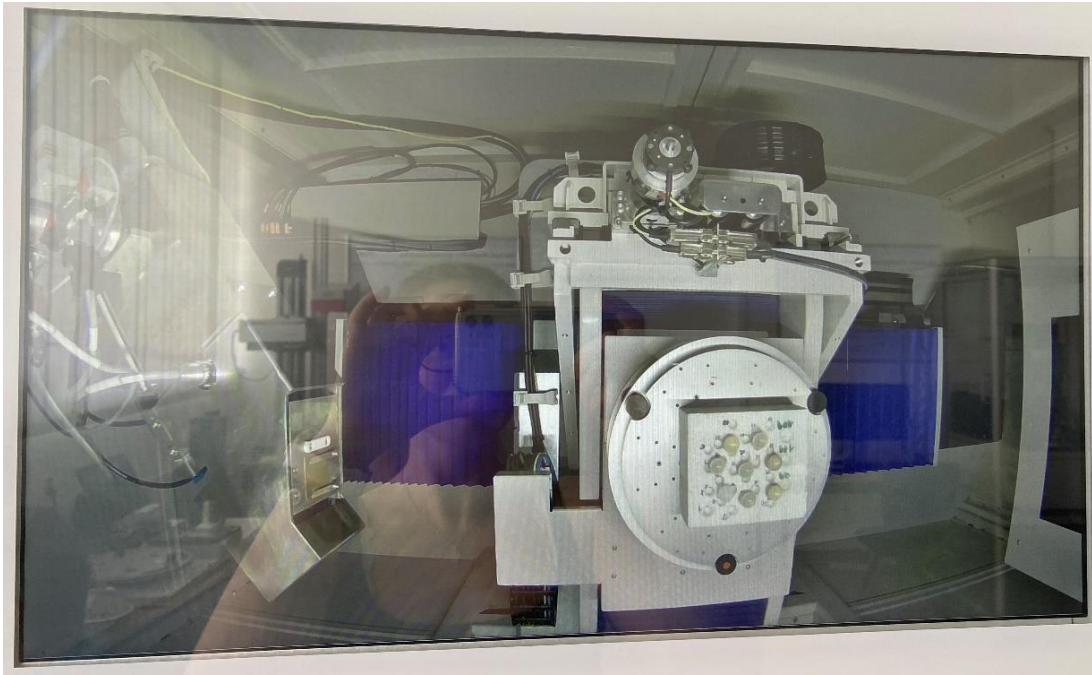
Obrázek 33 Fotografie monitoru vyobrazující pohled kamery, která se nachází uvnitř tomografu. Na fotografii jsou vidět i jednotlivé komponenty uvnitř zařízení - zleva: rentgenka (zdroj rentgenového záření), otočný stůl se vzorky, detektor – černý čtvercový terč (zachycuje rentgenové záření).
