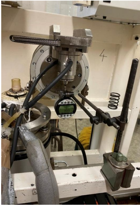
Obrázek 29 Umístění úchylkoměru pod hlavici v referenční poloze, tedy v 0^\circ flexe. Hrot úchylkoměru byl umístěn pod nejvyšším bodem hlavice.
