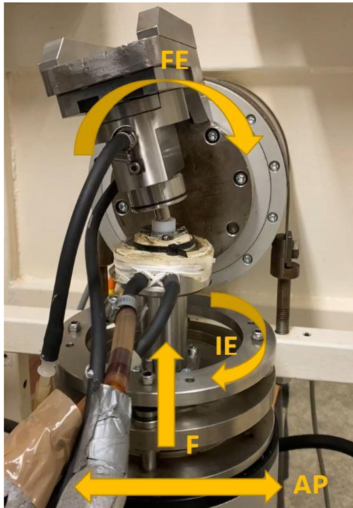
Obrázek 16 Schématické znázornění pohybů motorů
