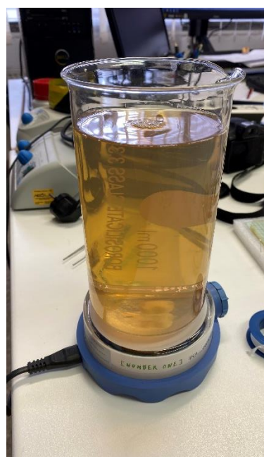
Obrázek 24 Výsledná směs maziva, které je na fotografii právě rozmícháváno, aby se přípravky co nejlépe spojily v jednu konzistentní tekutinu.
