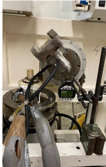
Obrázek 30 Úchylkoměr ve své poloze při rotaci motoru FE
