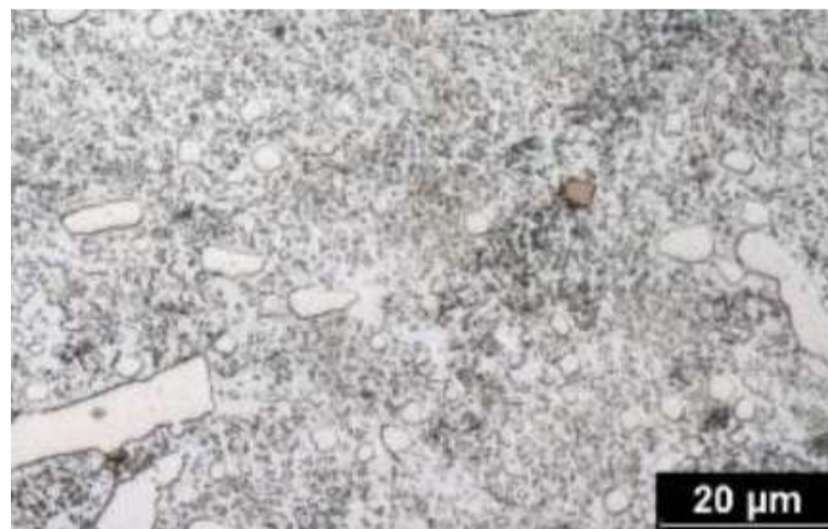
Obr. 1 Struktura nástrojové oceli X210Cr12 v dodaném stavu po žíhání na měkko [56]
