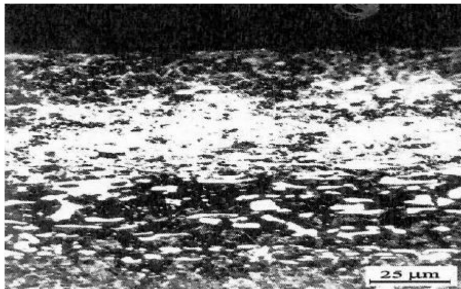
Obr. 25 Přítomnost \epsilon -fáze v okolí karbidů orientovaných rovnoběžně s povrchem.
