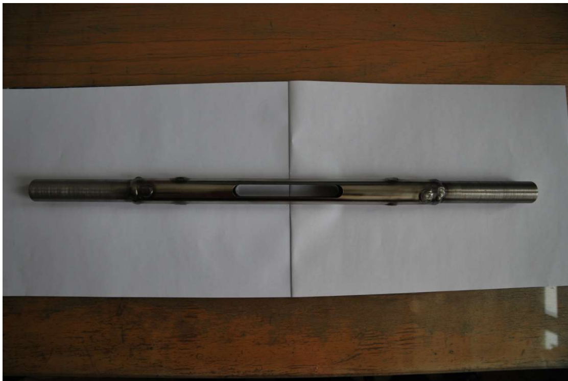
Obr. 4.3 – Typický zkušební vzorek, trubka TR25x1,5 mm
