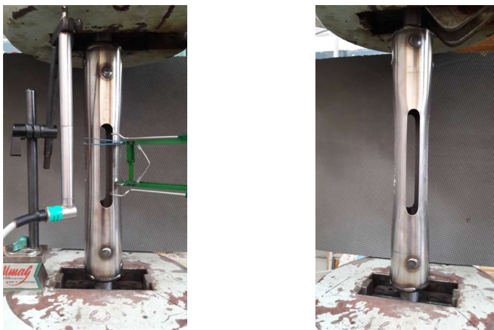
Obr. 4.7 – Konec tahové zkoušky na vzorcích \varnothing 50 \times 2,0 mm s patrným protažením vzorku
