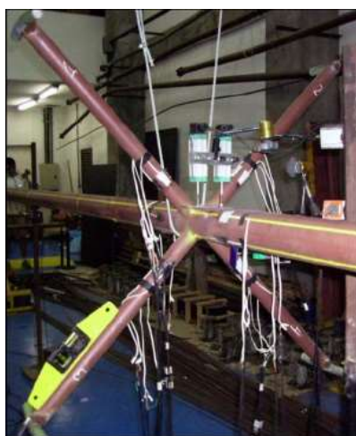
Obr. 2.15 - Experimenty provedené Araujem - vzpínadlový prostorový prut s křížem tvaru "x" a "+"
