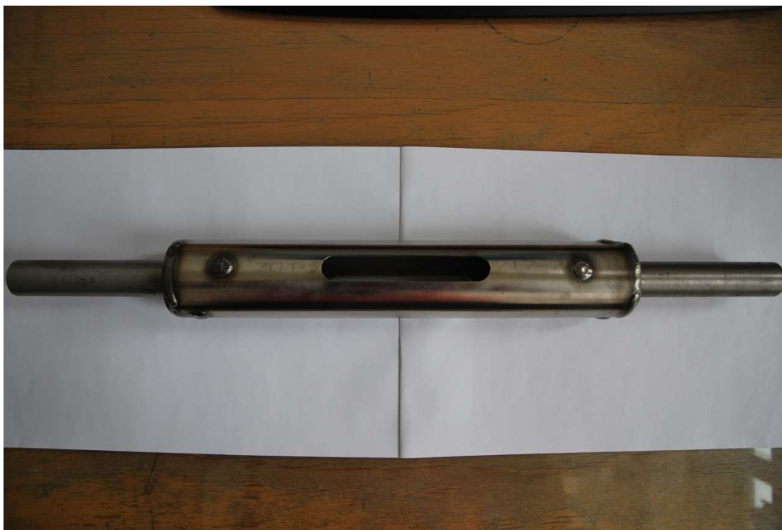
Obr. 4.4 – Typický zkušební vzorek, trubka TR50x2,0 mm
