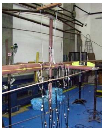
Obr. 2.15 - Experimenty provedené Araujem - vzpínadlový prostorový prut s křížem tvaru "x" a "+"
