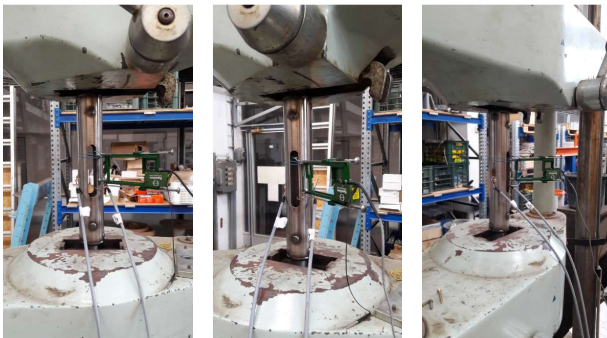
Obr. 4.6 – Upevněné vzorky ve zkušebním stroji s upevněným extenzometrem a nalepenými tenzometry
