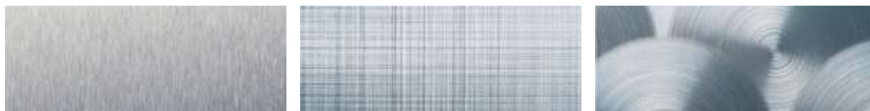
Obr. 1.1 - Úpravy povrchu nerezové oceli – broušení
