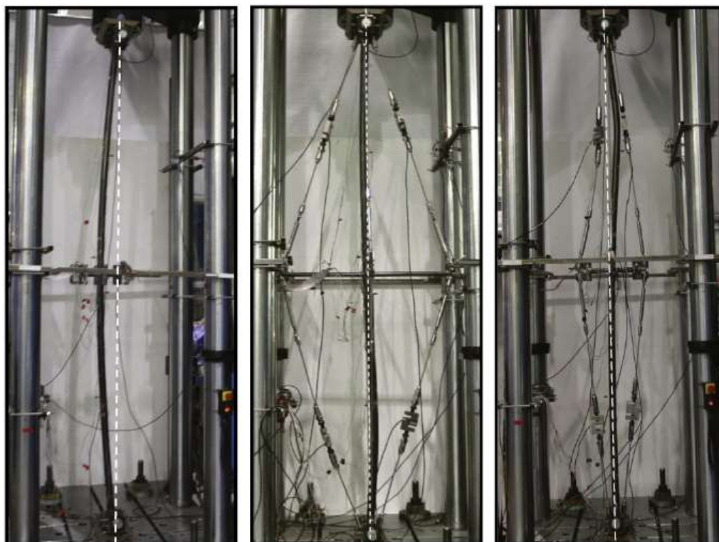
Obr. 2.15 - Tvary vybočení zkoušených vzpínadlových systémů podle napjatosti předpínacích lan a) vlevo symetrický tvar vybočení, b) uprostřed antisymetrický tvar vybočení, c) nesymetrický tvar vybočení
