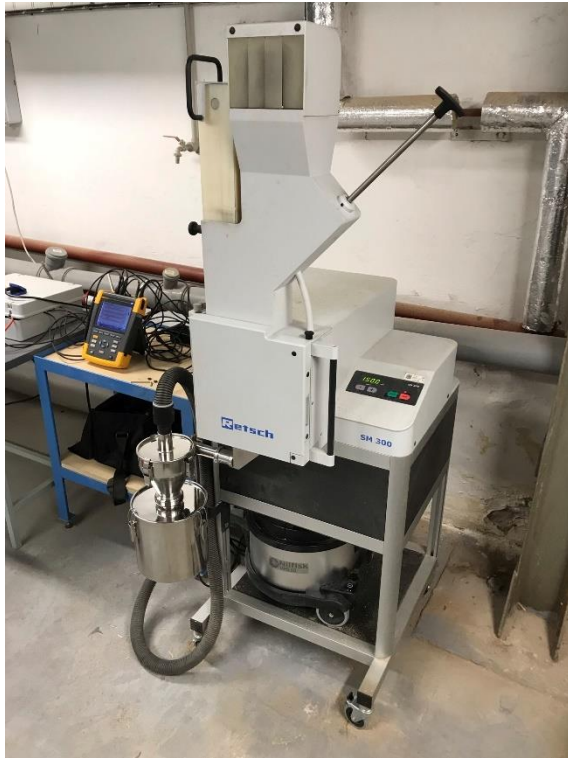
Obr. 15; Nožový mlýn Retsch SM300 a detailem na mlecí komoru s třibřítým rotorem a výměnnými propadovými sítí. (Vlastní, 2021)
