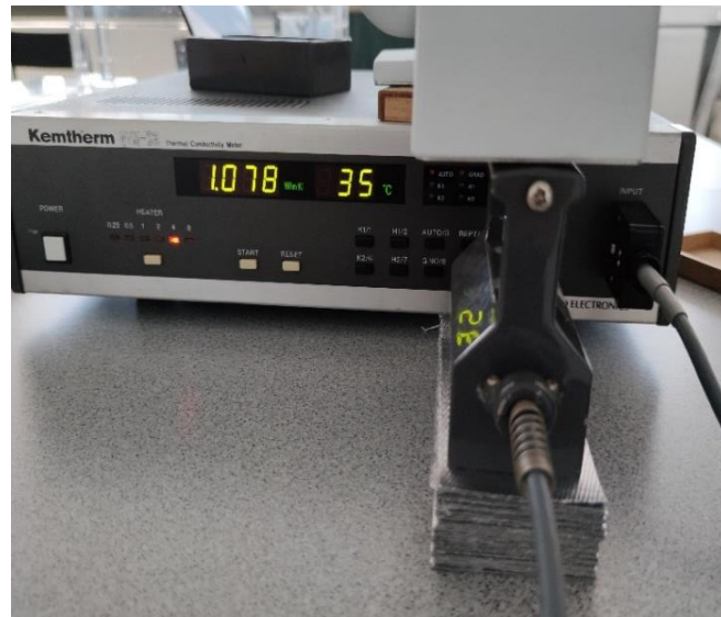
Obr. 47: Měření součinitele tepelné vodivosti
