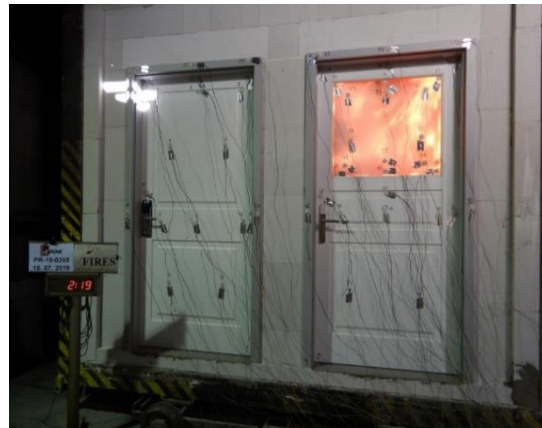
Obr. 20: Průběh zkoušky požární odolnosti požární textilie [31] Obr. 21: Průběh zkoušky požární odolnosti dveří [32]
