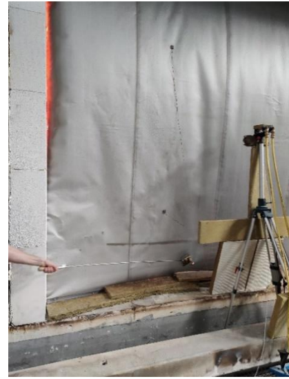
Obr. 42: Přiložení vaty pro měření celistvosti ve 104. minutě zkoušky
