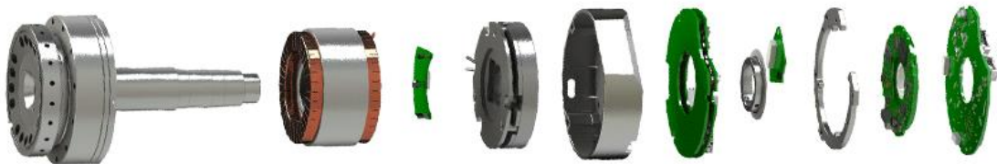
Obr. 14 – Rozpad mechanické stavby modulu rotačního kloubu RJSII [12]
