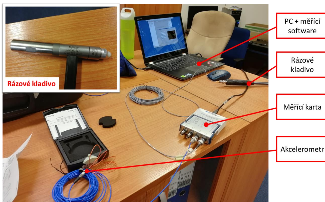
Obr. 3.16 Zapojení měřící aparatury pro cvičné měření FRF
