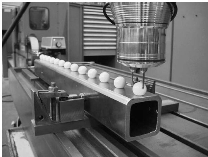
Obr. 2.15: Měřící artefakt a samocentrovatelná hlava [14]
