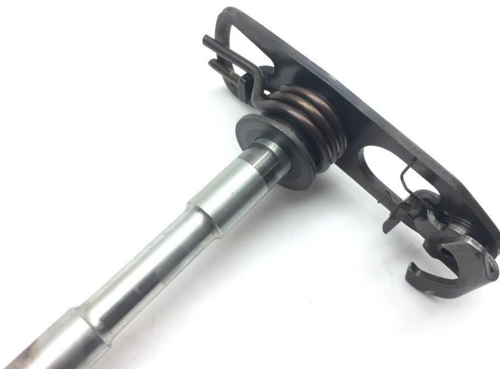
Obrázek 18 - Mechanismus řazení Yamaha YZF R1 [18]
