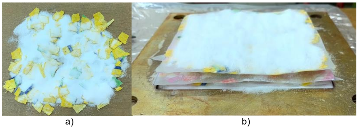
Obr. 51 a) příprava kompozitního prepregu s nastříhanou bavlnou, b) navrstvení jednotlivých prepregů za současného prosycení matricí
