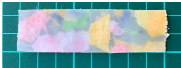
Obr. 52 Vzorek připravený spečením prepregů obsahující bavlněnou tkaninu
