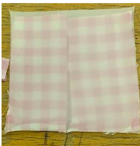
Obr. 49 sendvičový vzorek s použitím kontinuální bavlněné tkaniny
