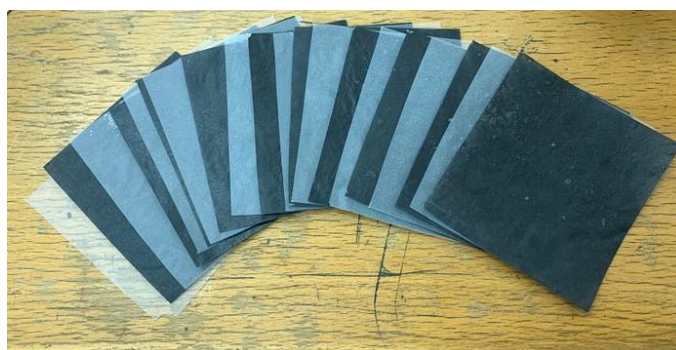
Obr. 39 navrstvení kompozitních prepregů a fólií z čistého PE – LD pro vytvoření vzorku s 5% hmotnostním podílem uhlíkové výztuže
