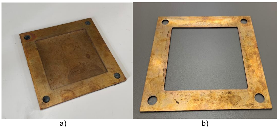
Obr. 28 a) měděná forma pro přípravu vzorků b) měděný rám formy
