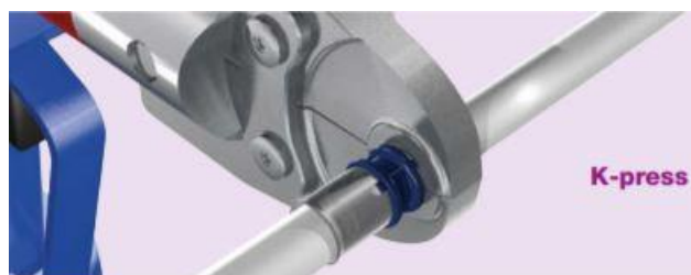
Obr. 32 Lisování plastového potrubí [31]
