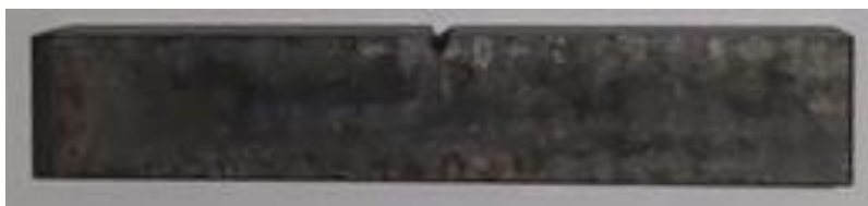
Obrázek 9 Zkušební vzorek s vybroušeným vrubem tvaru V
