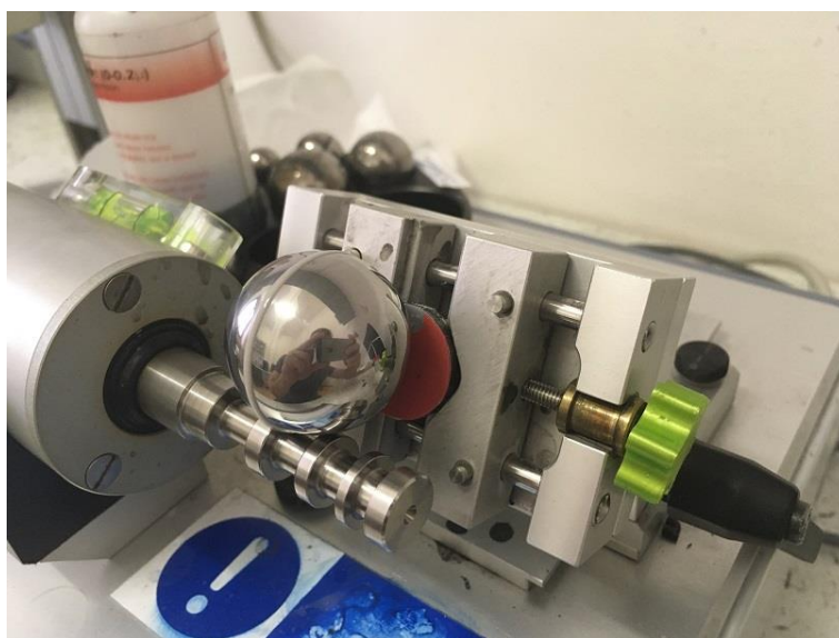
Obr. 3. Průběh orientačního měření na kalotestu
