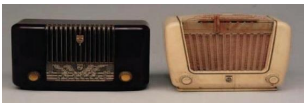
Obr. 3. rádio z bakelitu (vlevo), rádio z močovinné pryskyřice (vpravo), obě mají „knoflíky“ z nitrocelulózy [1]
