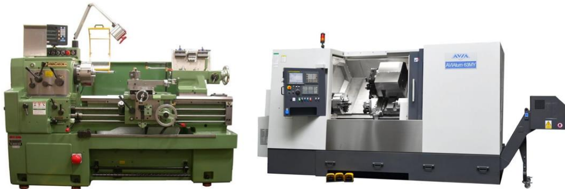
Obr. 2.1: Vlevo konvenční soustruh [4], vpravo CNC soustruh [5]
