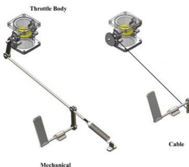
Obr. 4 - Mechanické ovládání škrtící klapky pomocí táhel (vlevo) a lanovodu (vpravo) [16]
