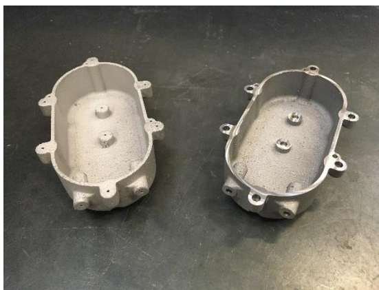
Obr. 26 - Kryt převodovky před (vlevo) a po (vpravo) obrábění
