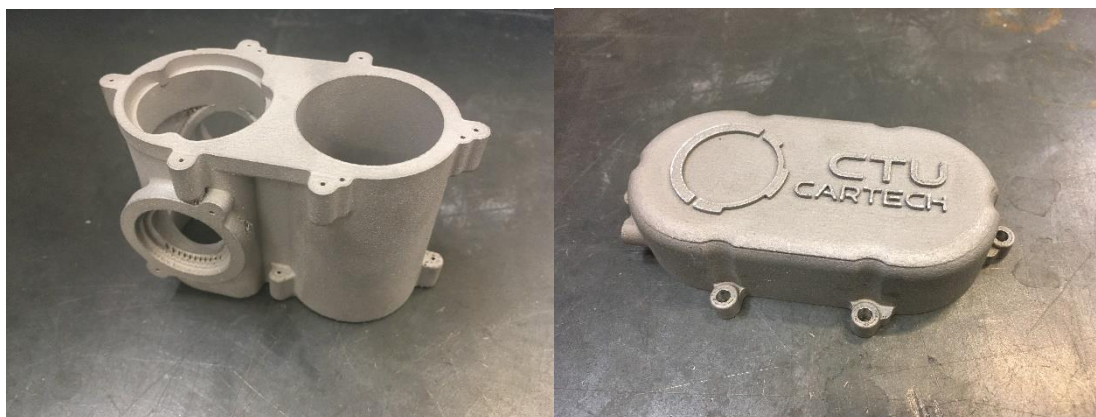
Obr. 22 - Polotovary tělesa škrtkící klapky a krytu převodovky vyrobené sintrováním hliníku
