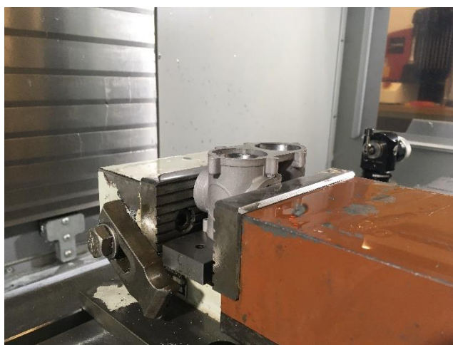
Obr. 23 - Upnutí tělesa při obrábění na CNC frézce
