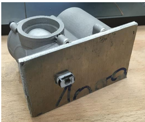
Obr. 24 - Přípravek zajišťující váleček proti pootočení během obrábění
