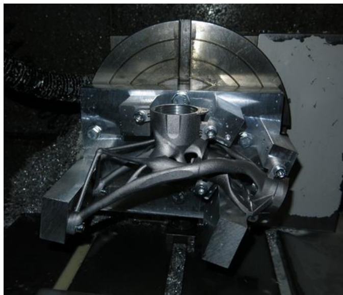
Obrázok 36 Diel v prípravku upnutom na lícnu dosku obrábacieho stroja
