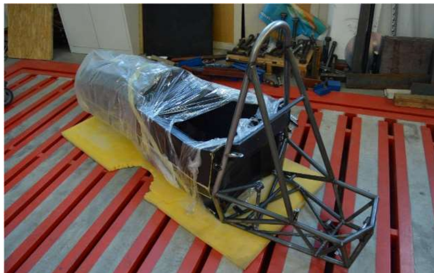
Obrázek 28: Monokok spojený s trubkovým rámem Dragon 9 [24]
