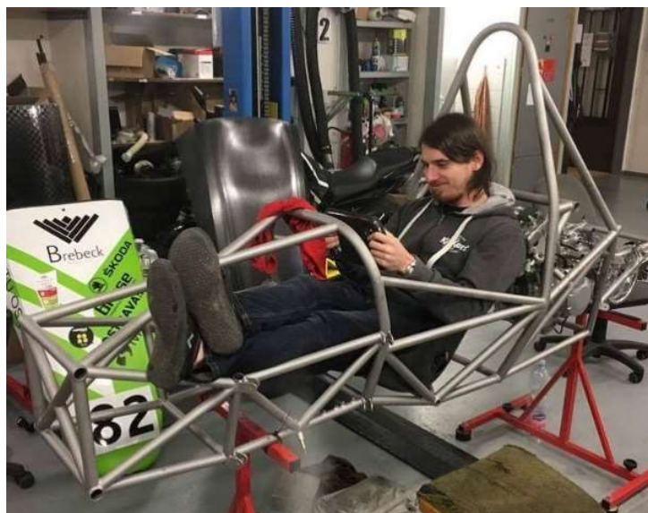
Obrázek 26: Celotrubková konstrukce VŠB [22]
