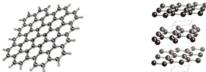
Obrázek 1.3: Základní struktury uhlíkových materiálů (grafen - vlevo, grafit - vpravo) [6]
