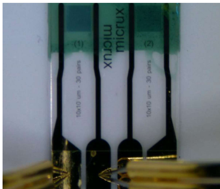
Obrázek D.4: Měření vodivosti filmu PANI-HCl na elektrodách Micrux
