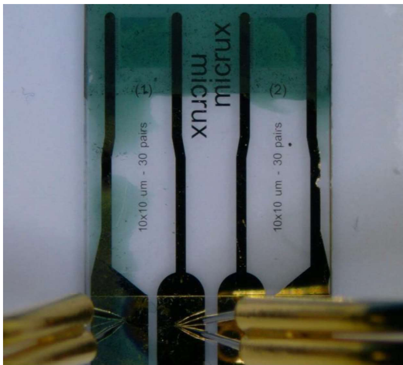
Obrázek D.5: Měření vodivosti filmu PANI-CH 3 COOH na elektrodách Micrux
