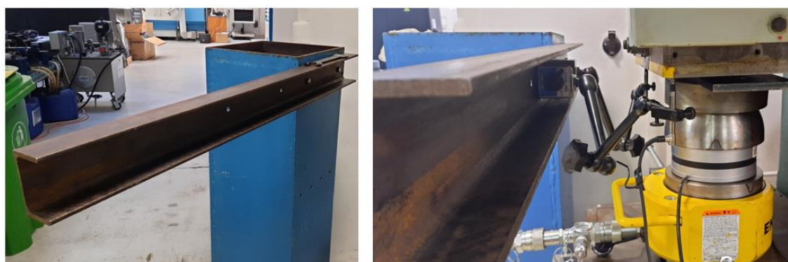
Obrázek 9.2: Upnutí úchylkoměrů na nezávislém rámu
