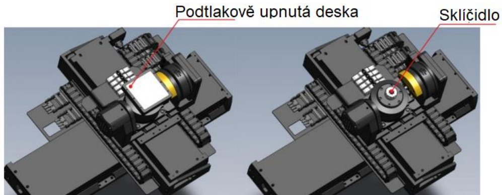
Obr. 29 Pohyblivé mechanické osy stolu laserového zařízení MASTER 1 (upraveno) [46]
