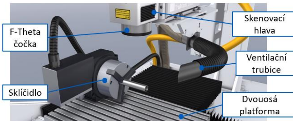
Obr. 18 Příklad kinematiky (3+1+2). Přídavné sklíčidlo (osa A) na stole [38]
