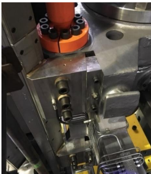
Obr. 4.26: Klínový mechanismus pro vymezení vůle vedení ve tvaru „X“.
