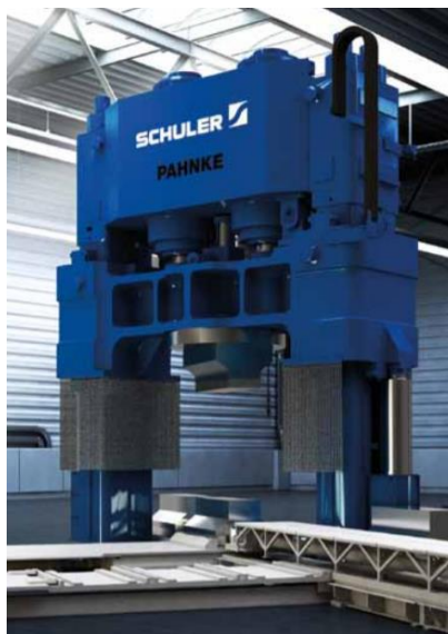
Obr. 4.23: Zachycení radiace pomocí řetězových závěsů [7].
