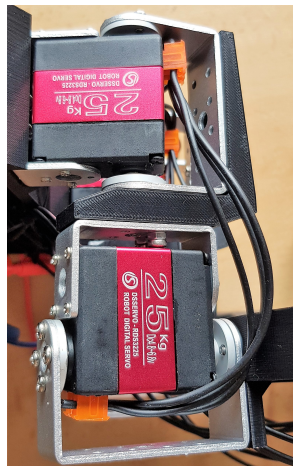
Obrázek 5.1: Smontovaná noha se zapojenými kabely - první část
