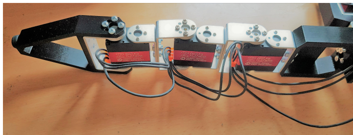
Obrázek 5.2: Smontovaná noha se zapojenými kabely - druhá část
