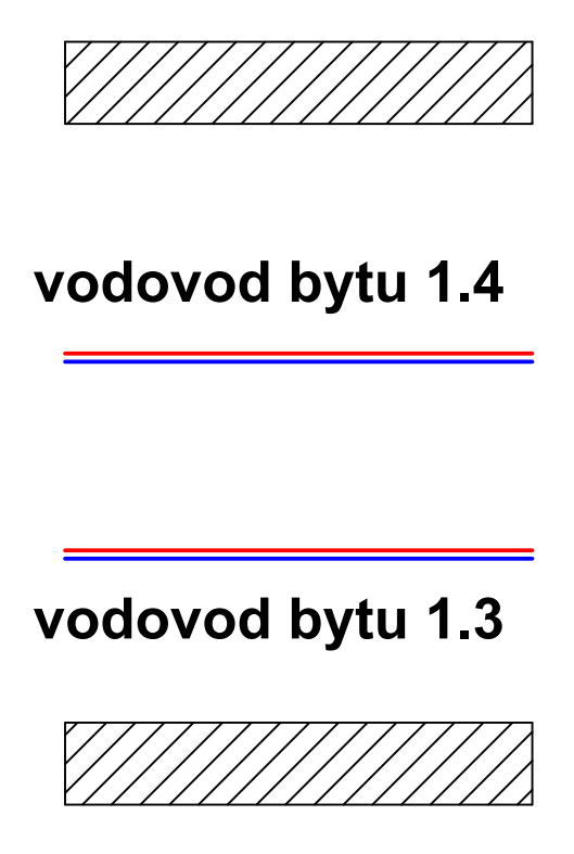
DETAIL 1 vedení vodovodu ve stěně
