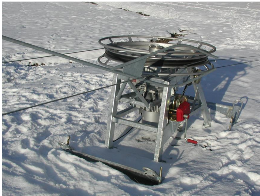
Obrázek 3.2: Poháněcí stanice zařízení s nízkým vedením lana [6]
