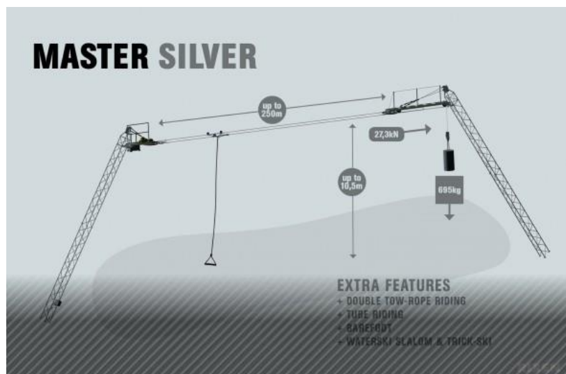
Obrázek 3.13: Schéma vleku Master Silver [4]
