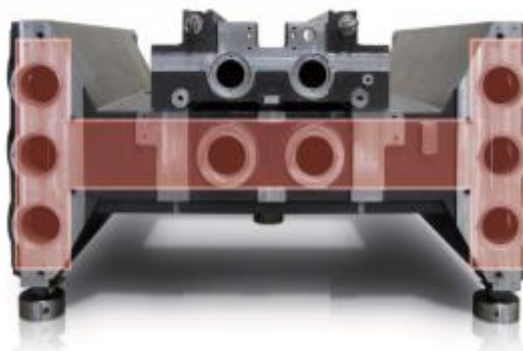
Obr. 6 - Protékaná konstrukce obráběcího centra Yasda YMC 430 Ver. II [12]
