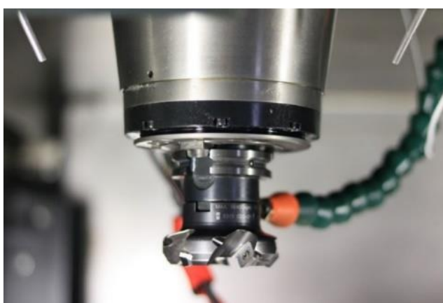
Obr. 16 - Umístění IR senzoru ve flexibilní hadici [17]
