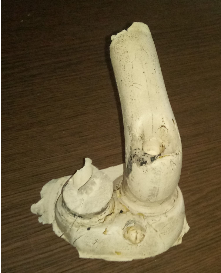
Obr. 2: Výsledný odlitek spalovacího prostoru a kanálu
