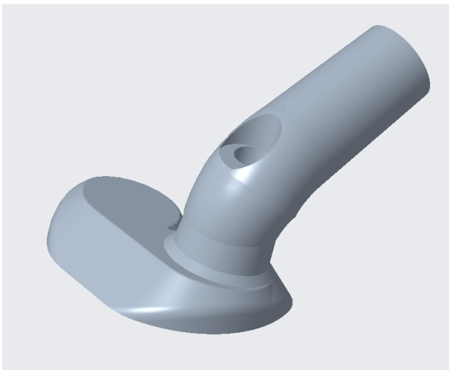
Obr. 6: Odečítání ventilového pouzdra a indentace kanálu pro možnost jeho ukotvení
