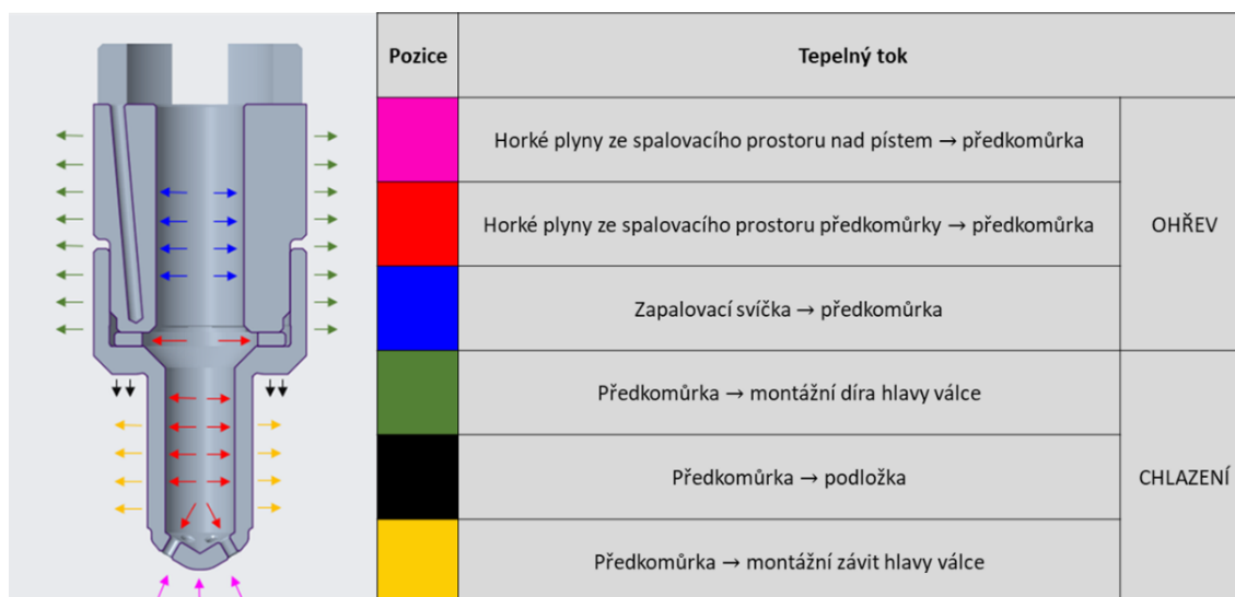
Obr. 7: Schéma tepelných toků působících na předkomůrku
