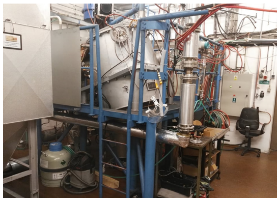
(b) Reaktor PLASGAS na ÚFP AV ČR
