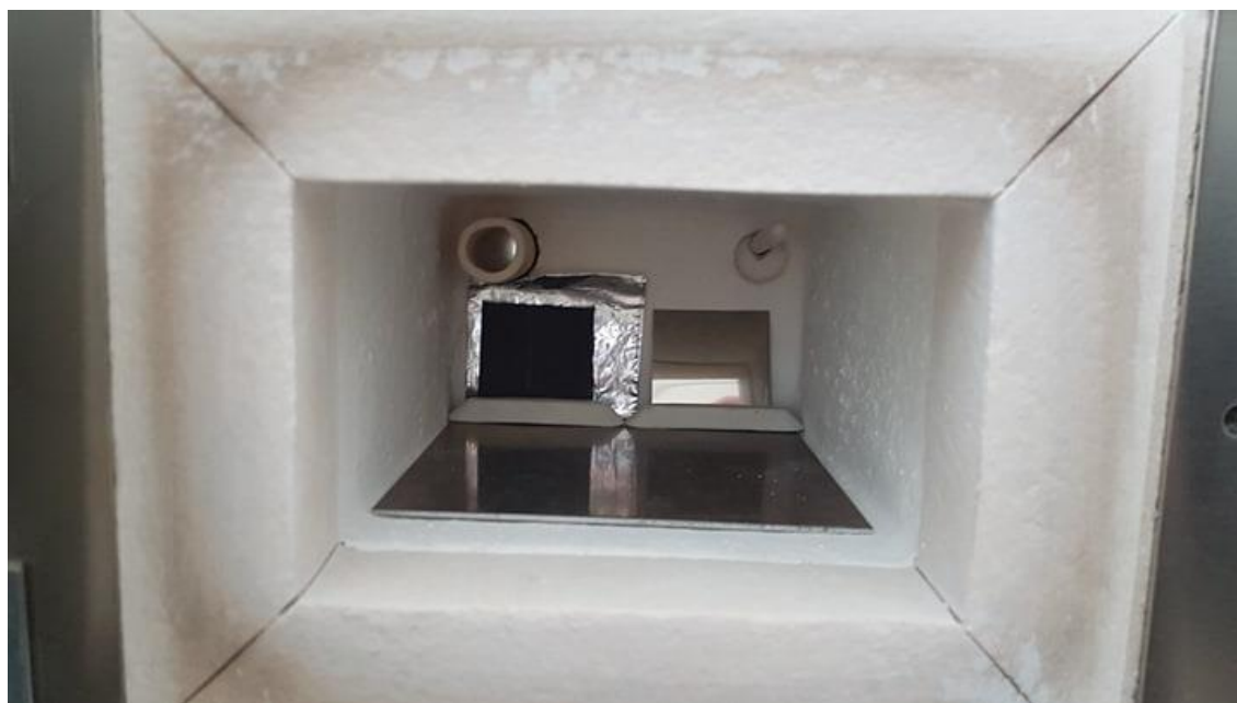
Obr. 25: Umístění kalibrační destičky (vlevo) a tantalové destičky (vpravo) v pícce. Převzato z práce [5].
