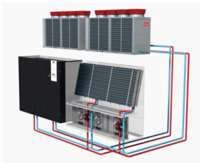
Obrázek 23 Zapojení klimatizační jednotky CyberAir 3PRO CW2 [45]
