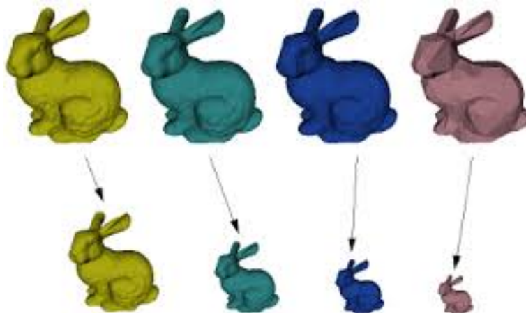
Obrázek 2.3. Princip použití různé úrovně detailu, Using LODs for distant objects [online]. In: . [cit. 2021-01-17]. Dostupné z: http://mkrus.free.fr/CG/LODS/xrds/
