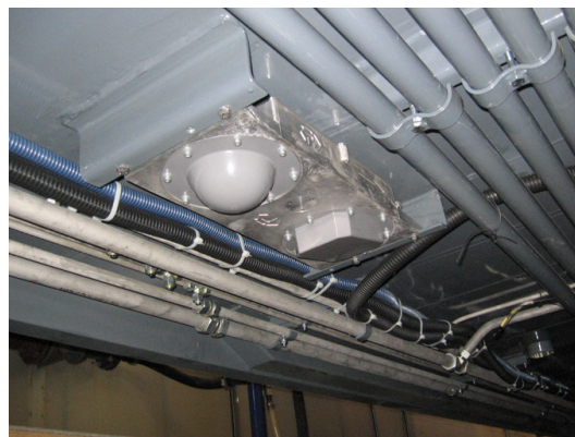
Obrázek 2.2. Dopplerův radar na podvozku vlaku [6]
