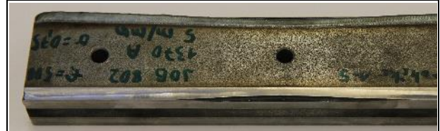
Materiál chybí na vnější hraně. Pro správné vyplnění materiálem je třeba zvýšit navařovací výkon, nebo zvětšit osovou vzdálenost hořáku o .
