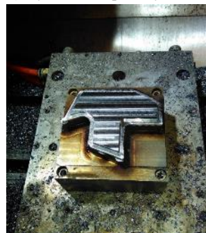
Obr. 12 Postup navaření jedné vrstvy dílce s komplexním tvarem vnější kontury
