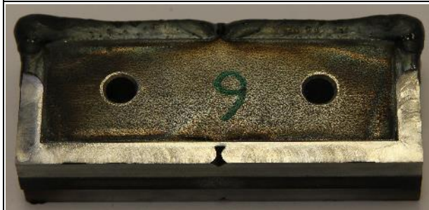
Obr. 12 Postup navaření jedné vrstvy dílce s komplexním tvarem vnější kontury
