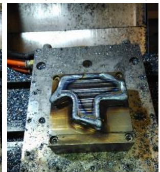
Obr. 12 Postup navaření jedné vrstvy dílce s komplexním tvarem vnější kontury
