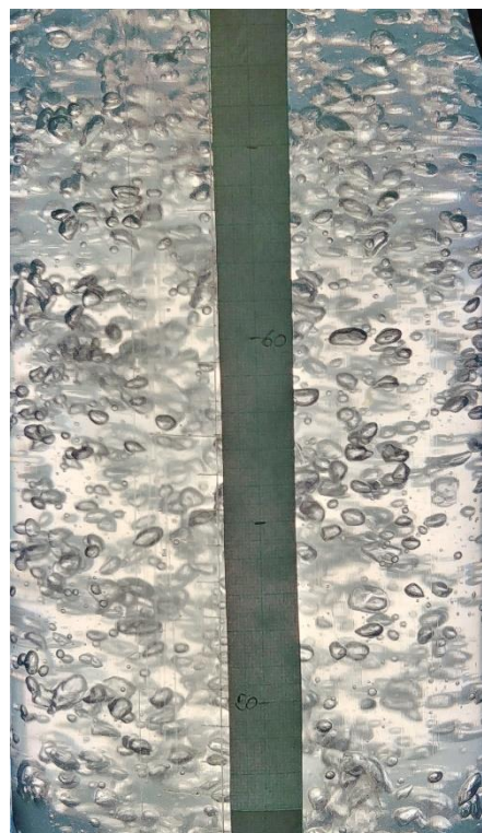
Obr. 12-5: Foto probublávané vrstvy a měřící milimetrové pásky.
