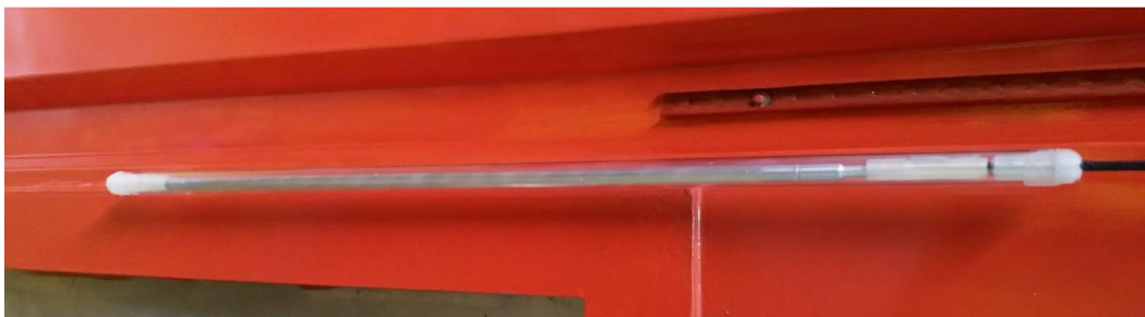
Obr. 6: Test rotačního oscilátoru s maketou palivového proutku.[1]
