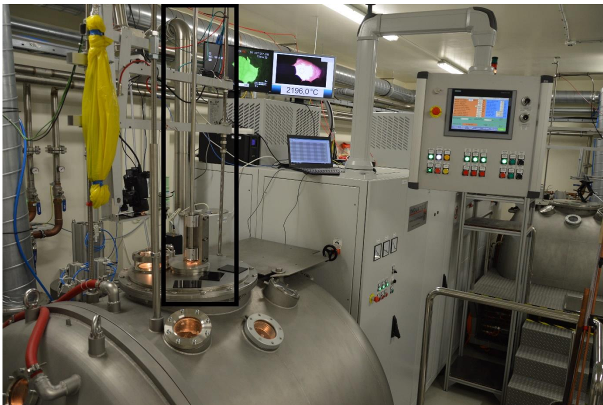
Obr. 2: Pracovní komora IS-1 s odběrovým zařízením (černé ohraničení).
