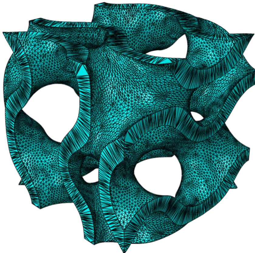
Obrázek 15: Výpočetní síť na Gyroidní struktuře
