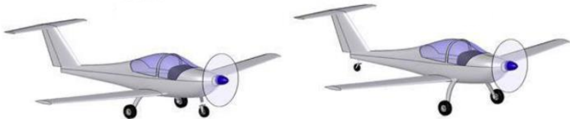
Obr. 24: Porovnání konceptů podvozku příďového (vlevo) a s ostruhou (vpravo)
