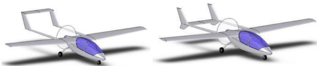
Obr. 9: Letoun s ocasními plochami konfigurace invertované U (vlevo) a U (vpravo)
